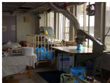
目だし帽づくりの作業場です。手前の機械が布の裁断機です。左のテーブルの上の布が裁断後のものです。
